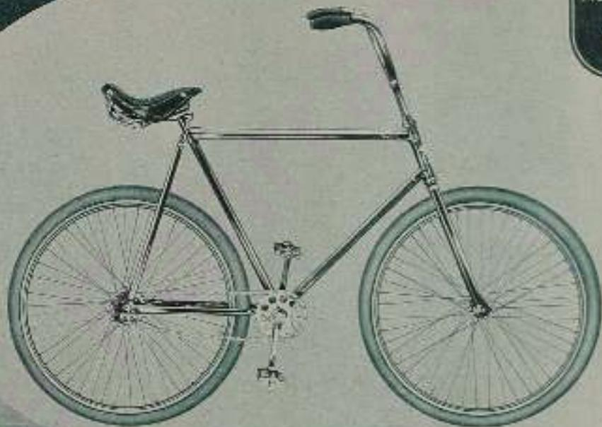
Nach internationalen Wettfahrbestimmungen gebaut. Vollständig vernickelt oder schwarz lackiert, 54 cm hoch, Holzfelgen mit Schlauchreifen 26 x 1 1/4", mit extra starken Naben, mit je 48 glatten, starken Stahlspeichen, Übersetzung 27 x 20-Zähne, 1/2 x 1/2" Teilung.
