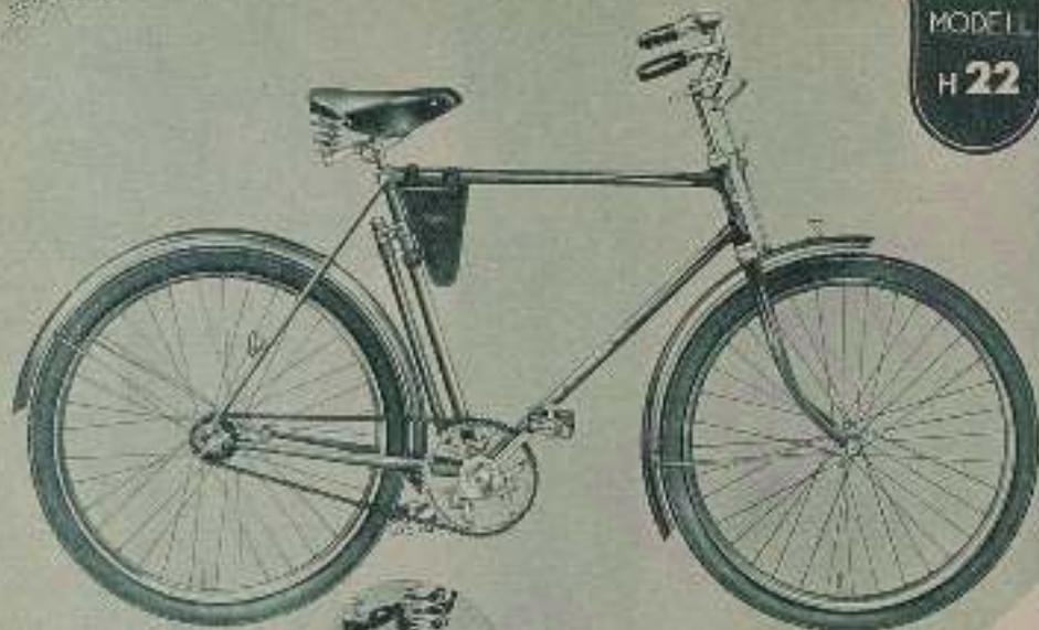
Rahmenhöhen: Bei Herrenrad 53, 56 und 61 cm, bei Damenrad 50 oder 55 cm, schwarze Lackierung mit ein- oder zweifarbig geflammtem Strahlenkopf und dazu passenden Zierlinien, blanke Teile auf Nickelunterlage verchromt.
