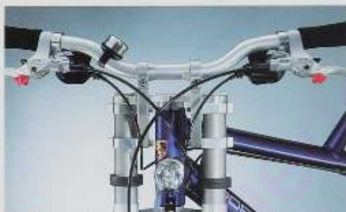
Optische Ganganzeige, 8-fach Direct-Speed Schaltwerk, Top-Pull-Umwerfer, Shimano NEXAVE STI Tap-Fine-Schaltgriffe
