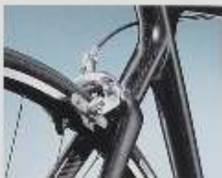
Hinterradbremse Shimano Dura Ace Dual Pivot SR-B
