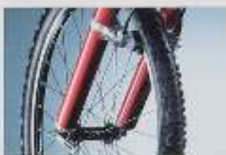
Vordergabel mit gepulvertem Tauchrohr und MAGURA HS 33 FHM Felgenbremse
