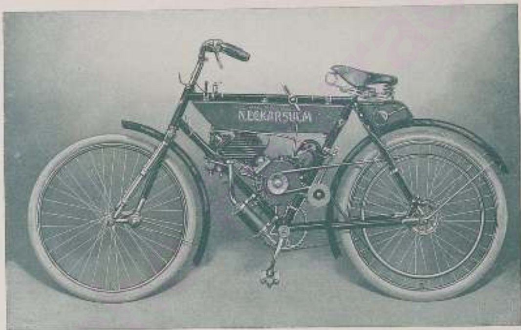
Neckarsulmer Fahrrad mit Motor 1\frac{1}{2} HP. mit Magnetzündung (D. R. G. M.) und Federgabel.
