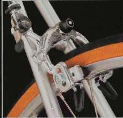
Alpha: Rotorfolgebremse mit Filzbrunzbitgel.
