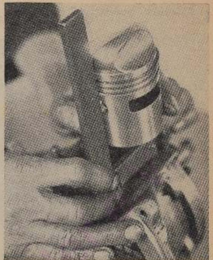
**Bild 9:** Betrachten Sie einmal die Form des Kolbenbodens. Es ist einleuchtend, daß die Gasführung im Zylinder gestört wird, wenn die Ablenk-nase so aussieht wie auf Bild 5. Achten Sie beim Auswinkeln darauf, daß der Gehäuseflansch sauber von Dichtungsresten ist, sonst gibt es Meßfehler. (120 ccm JLO-Motor.)
