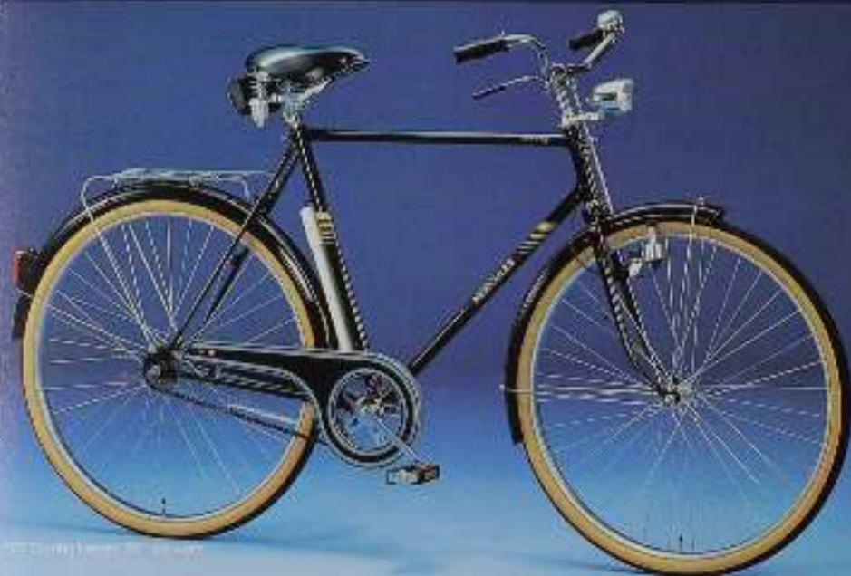
Ein solides ausgereiftes Qualitätsrad mit besonderer Bequemlichkeit. Geprägt wird dieses gediegene Fahrrad durch die in Rahmenfarbe lackierten Schutzbleche, den Rohrgepäckträger und das goldfarbene Dekor, handliniert. Das besonders schräg gestellte Sitzrohr ermöglicht bei bequemer Sitzposition einen kräftesparenden Schiebetritt. Außerdem erleichtern Glockenträger und SACHS-Freilauf-Rücktrittnabe die Fahrt.
