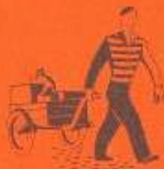
läßt sich der leichte Hahn-Motorradanhänger auch von Hand führen. Seine vorbereiteten Drahtspeichenräder mit Kugellagern laufen ebenso leicht wie geräuschlos und beanspruchen nur geringe Zugkräfte. Die Deichsel ist in bequemer Griffhöhe, so daß man leicht rangieren kann.
