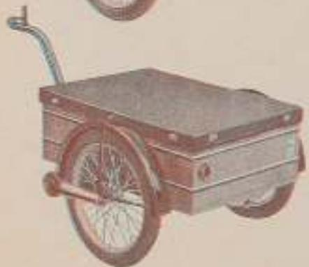
Typ MA 49 und MA 50: Wie M 49 bzw. M 50, jedoch mit wasserdichter Abdeckplane, leicht und sehr knipfbar. Gesamtladehöhe MA 49 = 700 mm, MA 50 = 600 mm. Gewicht MA 49 = 33,5 kg, MA 50 = 31,5 kg.
