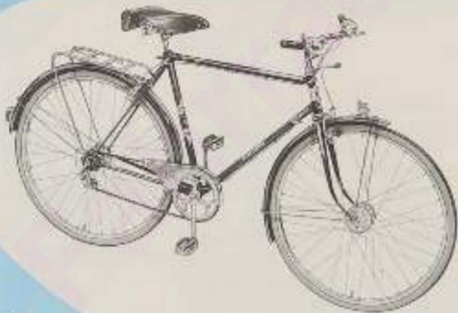
Diese Modelle sind auf Wunsch mit Torpedo-Dreigang-Freilauftrieb ohne Rücktrittbremse und mit zugehöriger F&S-Vorderrotationsnabe lieferbar.
