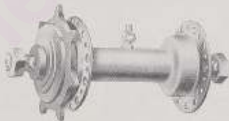
Renn-Nabe, extra breit, wodurch das Hinterrad besonders steif wird, da der Flansch für die Speichen an den Außenrand der Nabe gelagert ist.
