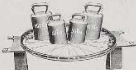
Holz-Belastung eines Rades
