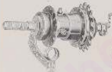
Freilaufnabe mit Doppel-Uebersetzung und Rücktrittsbremse.
