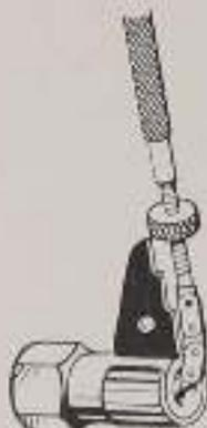
6. Ist dies nicht der Fall, so wird die Einstellhülse (nicht die Rändelmutter) nach links bzw. rechts gedreht, bis die Unterkante der Rändelmutter mit der nun in Frage kommenden Meßkante übereinstimmt. Zur Kontrolle Clickschalter wieder auf III stellen (Pedale bewegen). Die Unterkante der Rändelmutter muß wieder mit der Meßkante übereinstimmen. Andernfalls Einstellung neu vornehmen.
