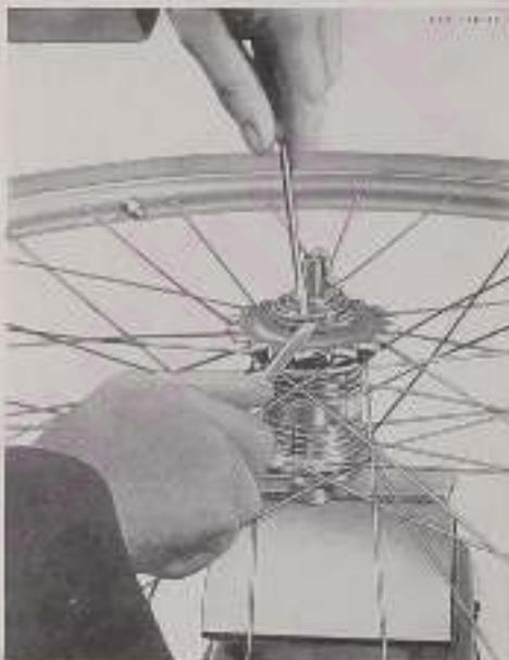
Man schraubt zunächst die Rändelmutter [52] vom Einstellbolzen des Zugkettchens (40), die Achsmutter und Kettenlennmutter von der Achse und hebt die beiden Fixierschrauben [2] ab. Das Achsende auf der Hebelseite wird unter Verwendung von Schutzbacken in den Schraubstock gespannt und der Zahnkranz-Federring [30] mit Hilfe zweier Schraubenzieher vorsichtig abgehoben. (Abb. 8)
