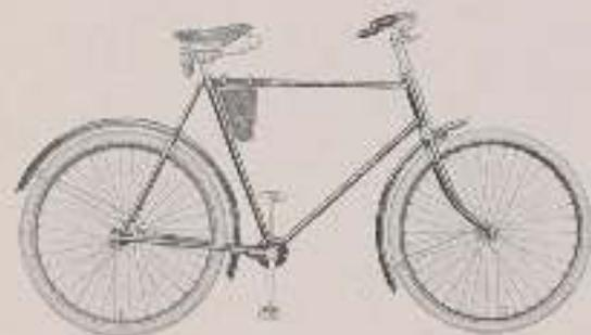
Anstatt des üblichen Kettenantriebes, bei dem der sich ansammelnde Straßenstaub in Verbindung mit Nässe leicht eine schmutzige Wirkung auslöst, geschieht bei dem konkurrenzlosen Dürkopp-Kardanrad die Übertragung durch eine Welle und die fast luftdicht eingekapselten Kegelzahnräder. Alle Teile laufen unter Verschluss, **kein Beinleid wird ölig** und **auch Hosenträger sind überflüssig. Die Reinigung des Rades ist denkbar einfach.**
