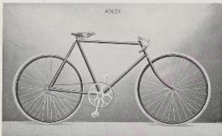
**Rahmen:** regulär 59,5 cm; hoch 64,5 cm; nieder 54,5 cm; extra-noch 69,5 cm. — **Räder:** 71 cm (= 28") — **Pneumatiks:** Drahtreifen 3,5 cm (= 1 1/2"); Wulstreifen 3,2 cm (= 1 1/4"). — **Uebersetzung** regulär: 213,4 cm (= 84"). — **Entwicklung:** 6,70 Meter. — **Gewicht,** mit Sattel und Pedalen ca. 11 kg.
