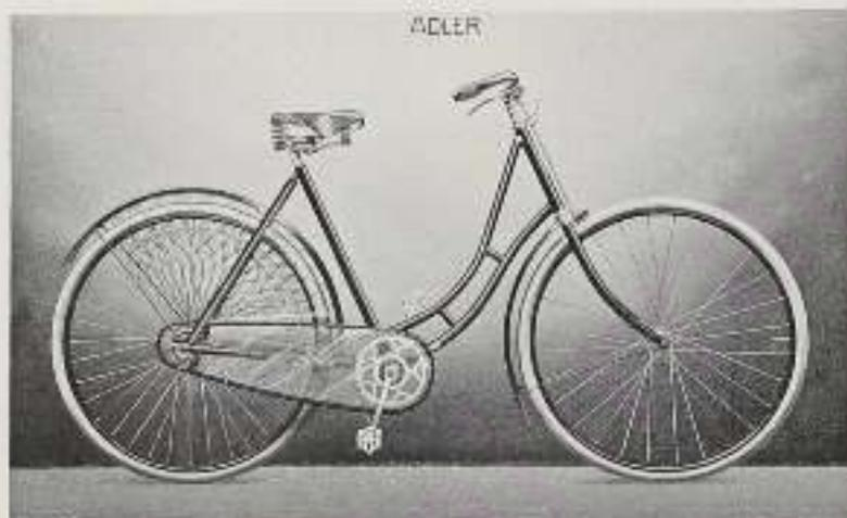
**Rahmen:** regulär 55,5 cm; hoch 61,5 cm; nieder 49,5 cm; extrahoch 66,5 cm. — **Räder:** nieder 66 cm (= 26"); regulär, hoch und extrahoch 71 cm (= 28"). — **Pneumatiks:** 3,8 cm (= 1 $\frac{1}{4}$ ""). — **Uebersetzungen:** bei 26" Rädern 170,9 cm (= 67,3"). Entwicklung: 5,37 Meter; bei 28" Rädern 173,8 cm (= 68,4"). Entwicklung: 5,46 Meter. — **Gewicht,** mit Sattel und Pedalen ca. 14,5 kg.
