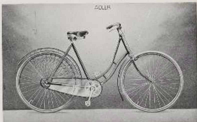
**Rahmen:** regulär 55,5 cm; hoch 51,5 cm; nieder 49,5 cm; extrahoch 66,5 cm. — **Räder:** nieder 66 cm (= 26"); regulär, hoch und extrahoch 71 cm (= 28"). — **Pneumatiks:** 3,8 cm (= 1 1/2"). — **Uebersetzungen:** bei 26" Rädern 170,9 cm (= 67,3"). Entwicklung: 3,37 Meter; bei 28" Rädern 173,8 cm (= 68,4"). Entwicklung: 3,46 Meter. — **Gewicht,** mit Sattel und Pedalen ca. 14,5 kg.
